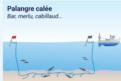
Plusieurs hameçons (jusqu'à 12 000) munis d'appâts sont fixés le long d'une ligne (<20 km) déposée par le bateau sur le fond ("calée") ou en surface ("dérivant").
