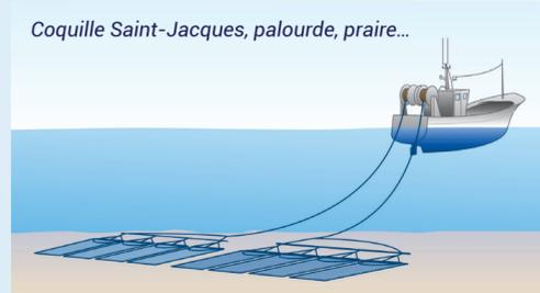
Des filets en forme de poche sont fixés à une armature équipée de dents métalliques qui ratissent le fond et font sortir les coquillages alors capturés dans la poche.
